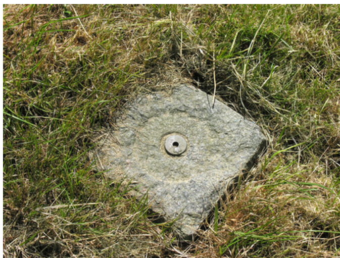
5: Geodætisk målepunkt / fikspunkt i højtop.
